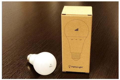
※口金: E26、周波数: 50/60Hz 共用、定格電圧: 100V、明るさ:電球 40W 形相当、発光効率: 80lm/W、色温度: 3,000K - 4,000K (電球色)、定格寿命: 30,000 時間、定格消費電力: 5 - 7W、使用環境温度-10℃~40℃、調光器非対応、通信モジュール内蔵、生産: 中国 ※管理画面で明るさを電球 20W 形相当・40W 形相当・60W 形相当に変更できます。
